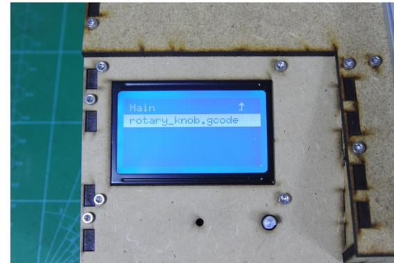
Drehknopf zur gewünschten Datei drehen. Zum starten des Drucks, Drehknopf drücken.
