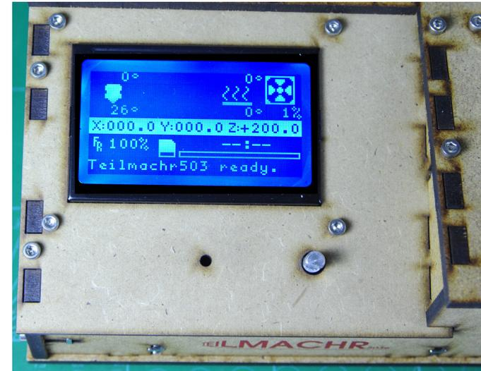
Durch das Drücken und Drehen am Drehknopf steuert man durchs Menü.
