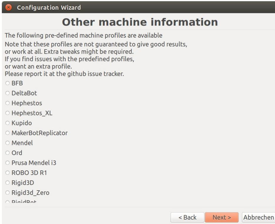
Hier muss man das Modellspezifische Maschinen Profil auswählen. Im Moment ist das durch einen Software Bug gar nicht so einfach, da die untersten Einträge nicht mehr sichtbar sind. Hier kann man sich mit der Tabulatortaste helfen. Einfach so lange die Tabulatortaste drücken, bis der Fokus auf „Next“ liegt, dann mit Shift + Tabulatortaste eins zurück. Dann hat man die richtige Auswahl.
