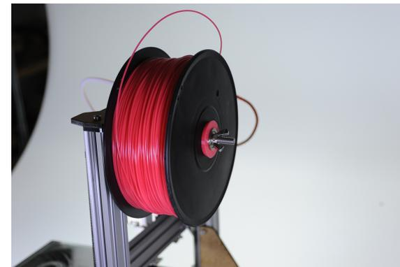
Materialrolle und die zweite Spulennabe montieren und mit Flügelmutter befestigen.
