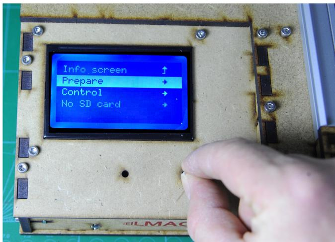
Einmal drücken bringt die Menüübersicht hervor. Drehen nach rechts verschiebt die Auswahl. „Prepare“ auswählen und drücken.
